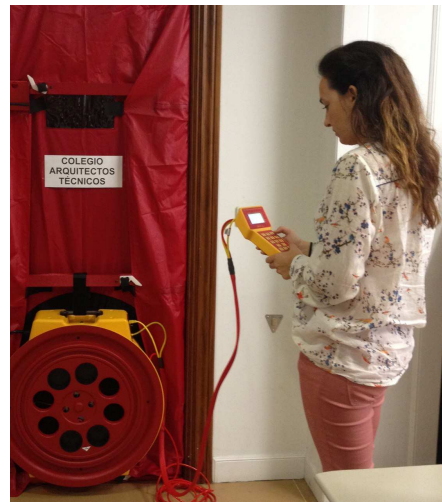
Begoña Anaya comprueba la estanqueidad de una vivienda. FOTOS: CEDIDAS
